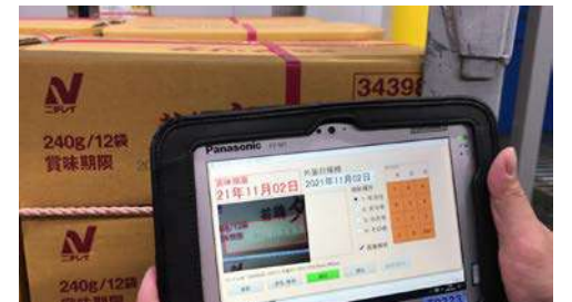
※賞味期限自動読取AIソリューション:AI-OCR(Optical Character Recognition/Reader:光学的文字認識)と画像認識による画像前処理技術によって、画像から賞味期限の文字を識別し、認識された賞味期限情報をクラウド上で突合することで、より高精度な読取を可能とするもの
