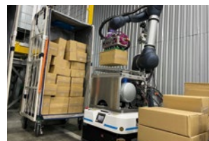
積み付け作業を行うロボット
