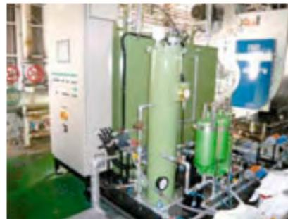
廃食用油を処理し燃料を混合する装置
