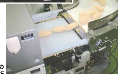
コンベアの段差防止金属板
