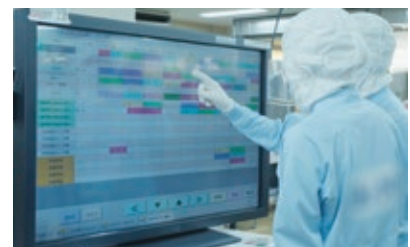
1工場で最大16兆通りの組み合わせがある中から、日別のラインごとの生産商品・生産量などの生産計画、作業者のシフトスケジュールなどの要員計画を自動立案。
